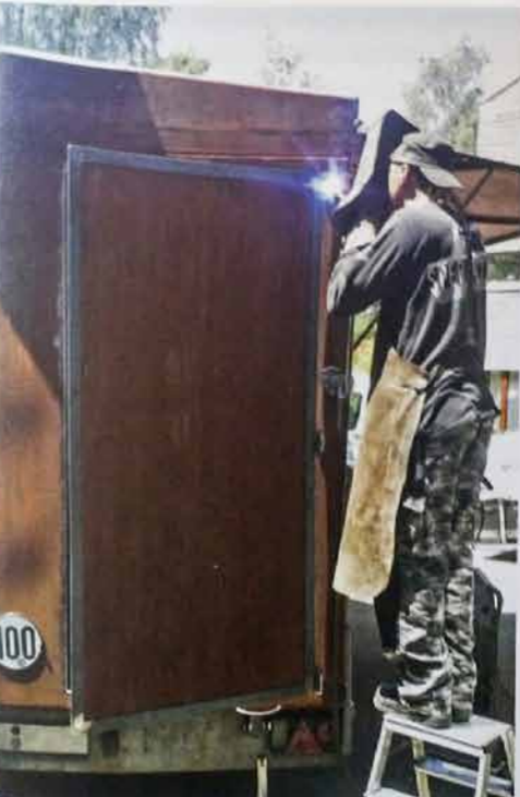
...baute Vermeulen nachträglich noch eine Tür ein (links). Rechts und unten der Innenraum vor der Behandlung mit Eisen(III)-chlorid, ganz unten der Hänger vor dem Umbau
