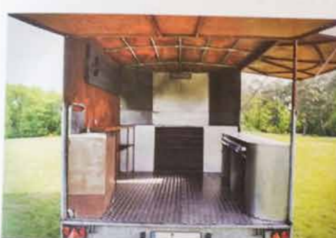
Der Fußboden besteht aus Aluminium, der Rest aus Schwarzstahl. Und weil die Heckklappe so schwer zu öffnen ist...
